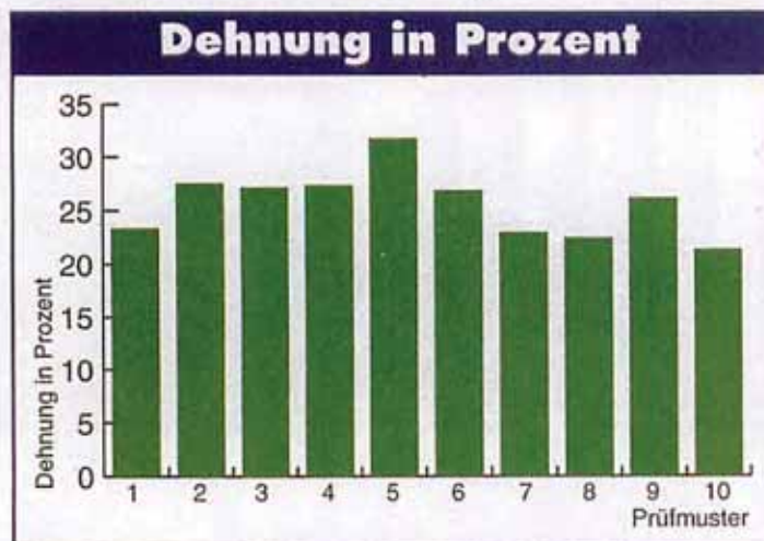
Über 30 Prozent Dehnung können Monofile aufweisen
